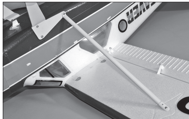
Desserrer les vis des étais d'aile et retirez les étais.
