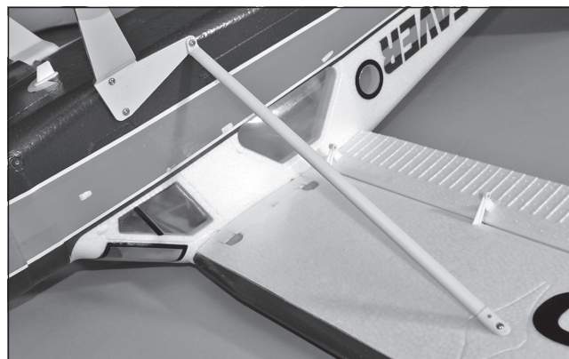
Schrauben der Tragflächenstreben lösen, Streben abnehmen.
