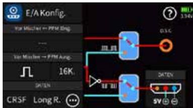
Empfohlene ELRS-Module sind das „Jumper AION 2,4GHz“-Modul oder ein „BetaFPV True Diversity/Gemini SuperD Empfänger“ mit „RXasTX“ auf dem Datenport mit der Einstellung für das „CRSF“-Protokoll. Ebenso können Diversity Empfänger mit ESP32 Prozessor mit „RXasTX“ als Sendemodul verwendet werden.
