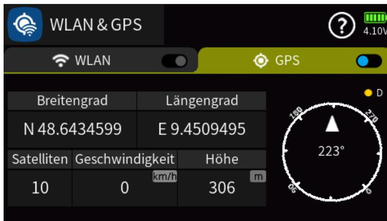
... eingeschaltet, wird –sobald die GPS-Geschwindigkeit des Modells gleich 0 ist und mehr als 6 Satelliten gefunden wurden – die „Home“ Position im GPS-Display vom internen GPS bestimmt. So ermöglicht diese Trennung zwischen „Modell“- und „Sender“-GPS-Position beispielsweise bei der Modellsuche die gezielte Annäherung an das gesuchte Modell:
